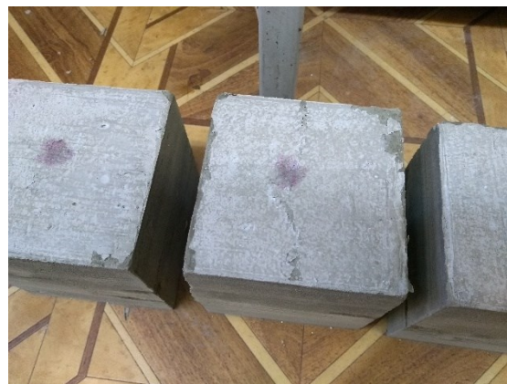
Рис. 8. Окраска фенолфталеина на поверхности кубиков без добавок. Почти полное отсутствие окраски говорит о \text{pH} \gg 10,5
