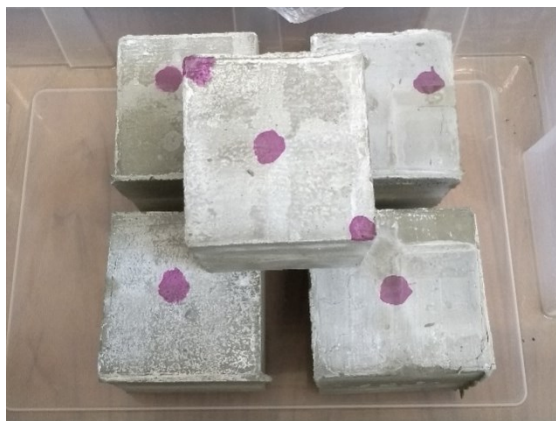
Рис. 7. Окраска фенолфталеина на поверхности кубиков с ускорителем твердения. Окраска говорит о 9 < \text{pH} \leq 10,1
