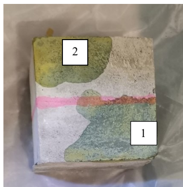
Рис. 9. Окраска универсального индикатора на поверхности карб. кубика 3 \times 3 \times 3 см с ускорителем твердения (неорг. фториды). Окраска в зоне 1 говорит \text{pH} \approx 10,5 . Окраска в зоне 2 говорит 7 < \text{pH} \leq 8
