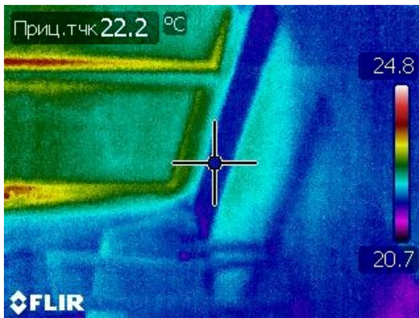
Рис. 3. Тепловой портрет стеклопакета и светового пятна на деревянном полу (изображение с поворотом на 90^\circ )
